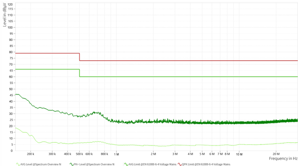
Rys. 8.7.1 Pomiar poziomu emisji przewodzonych w zakresie częstotliwości 150kHz ÷ 30MHz, linia N
