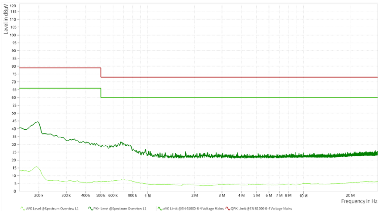
Rys. 8.7.3 Pomiar poziomu emisji przewodzonych w zakresie częstotliwości 150kHz ÷ 30MHz, linia L
